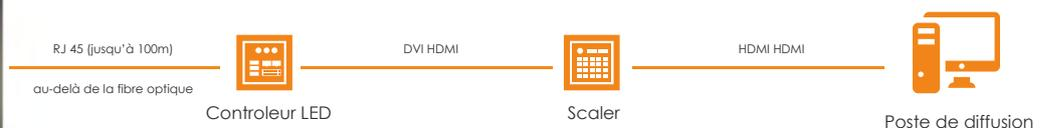
Contrôleur permettant de décomposer l'image source et de répartir sur l'ensemble des dalles afin d'obtenir une seule dalle d'écran. Le contrôleur peut gérer jusqu'à 2 murs d'images.
